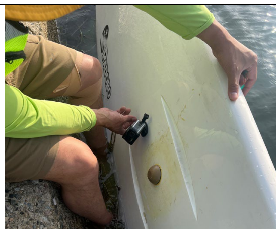
SUPの下部に設置したGoProとDeeper
