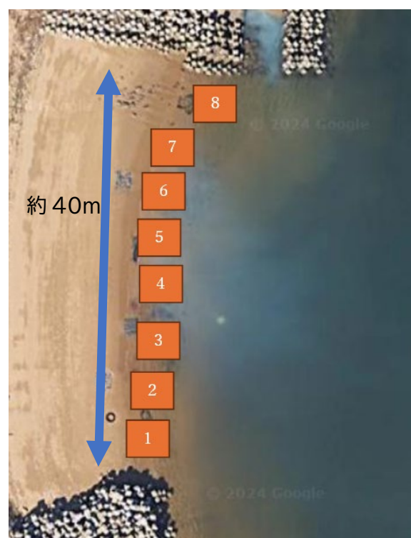
図2.1-20 ケアシェルネット設置箇所 海岸にそって8地点に設置
