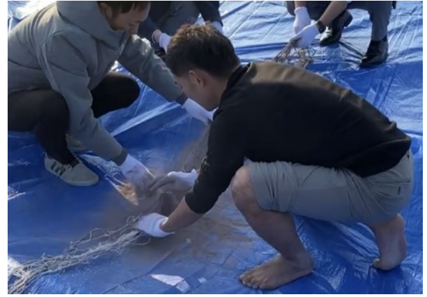
ゴム液に浸した網に ウニ殻粉末を付着させている様子
