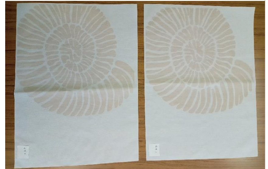
A3サイズランチョンマットの捺染。 水準1の方が色むらは少ないものの、浸漬式に比べると色が薄い。
