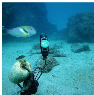
温度ロガーの設置状況
