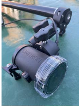
図 3-1 モニタリングで使用した水中カメラ・水中ドローン
