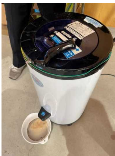
図 87 脱水機で脱水
