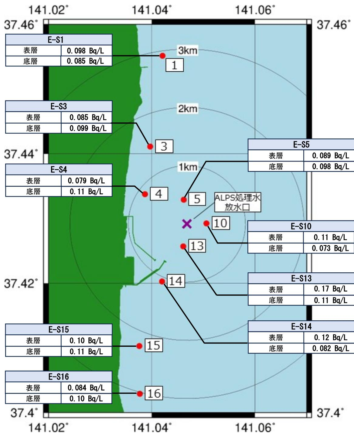
図1 ALPS 处理水放水口から 3 km 圏内の測点
