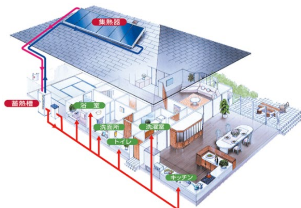
図 4-50 再生可能エネルギー熱の導入：太陽熱
