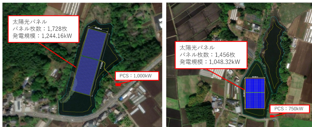
図 26 東池・西池における水上太陽光発電配置
