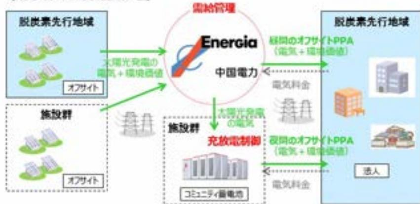
これらの需給管理や蓄電設備の充放電制御にあたっては脱炭素先行地域、市有遊休地群の再生エネルギー予測・需要予測、及びエリア内の蓄電池に対して、VPPを活用して統合的な充放電計画・制御を行うことにより、再生可能エネルギーの地産地消を進め、エネルギーコストの削減を図る。
