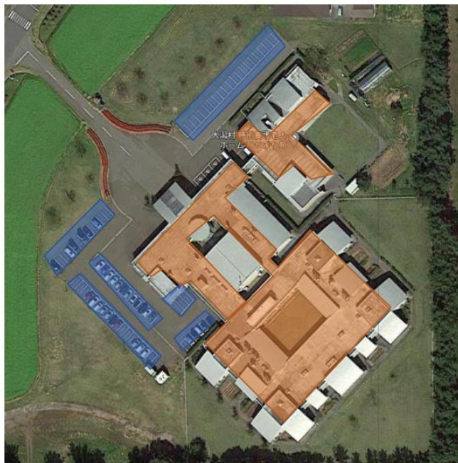
図表 11 太陽光発電の設置レイアウト・発電量試算のイメージ（ひだまり苑）
