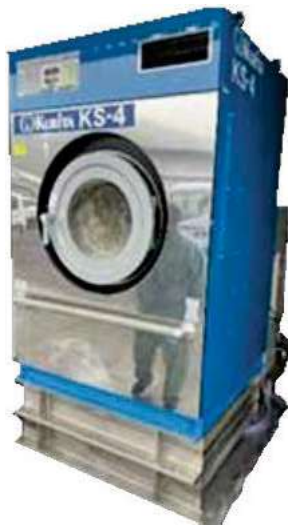
使用済紙おむつ分別処理の試験ユニット（一部）
