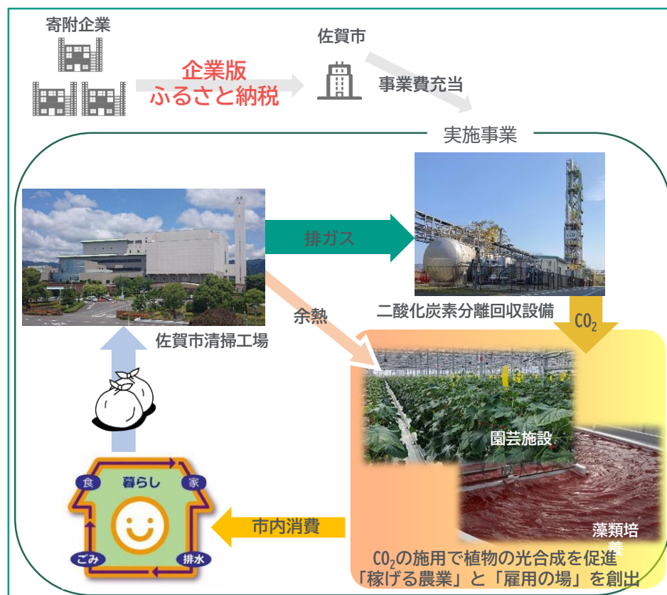
清掃工場を核とした脱炭素・資源循環に関する取組
